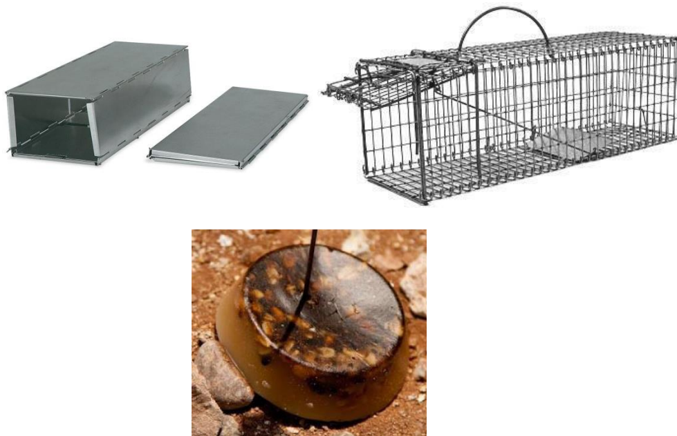
Figura 8. Dispositivos de detección de roedores. Arriba: trampa Sherman (izquierda) y trampa Tomahawk (derecha). Abajo: bloque indicador.
