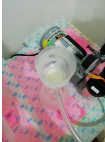
Figura 10. Detalle del material para filtrado (bombas de vacío, frasco kitasato con el filtro para el agua) (Fotografía: Erika Alarcón Chavira/CONANP, 2019).
