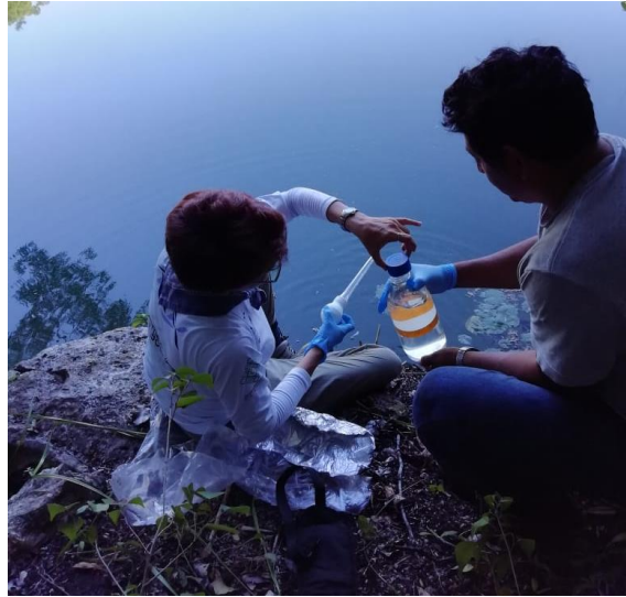
Figura 8. Toma de muestra de 1 L de agua en una botella de CIVEQ® esterilizada. Fotografía: Erika Alarcón/ECOSUR, 2019.
