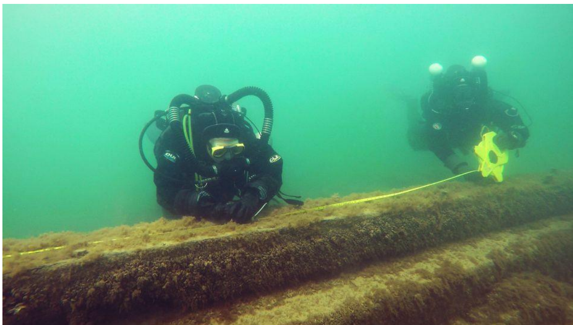
Figura 6. Buzos en el lago Michigan tomando datos de una tubería infestada de mejillones cebra. Tomado de Briscoe, 2017.
