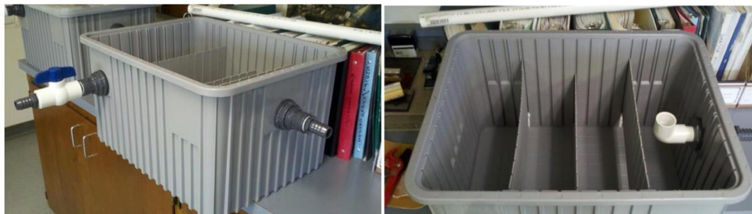
Figura 3. Biobox en donde se muestran los tubos de conexión con la toma o la salida del agua y el interior diseñado para la fijación de las larvas (Tomado de CDFW, 2019)
