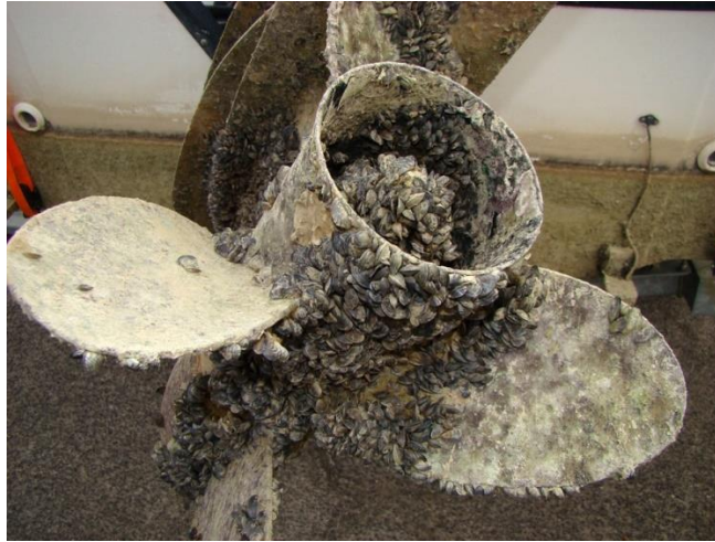
Figura 35. Hélice de bote colonizada por mejillones quagga en el Lago Mead. Foto: Natalie Boren. Tomado de https://www.deseretnews.com/article/900007355/deer-creek-declared-free-of-quagga-mussels-after-3-year-surveillance.html
