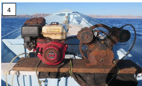
Figuras 4 y 5. Planta con compresor para buceo tipo Hooka y buzo usando Hooka.
