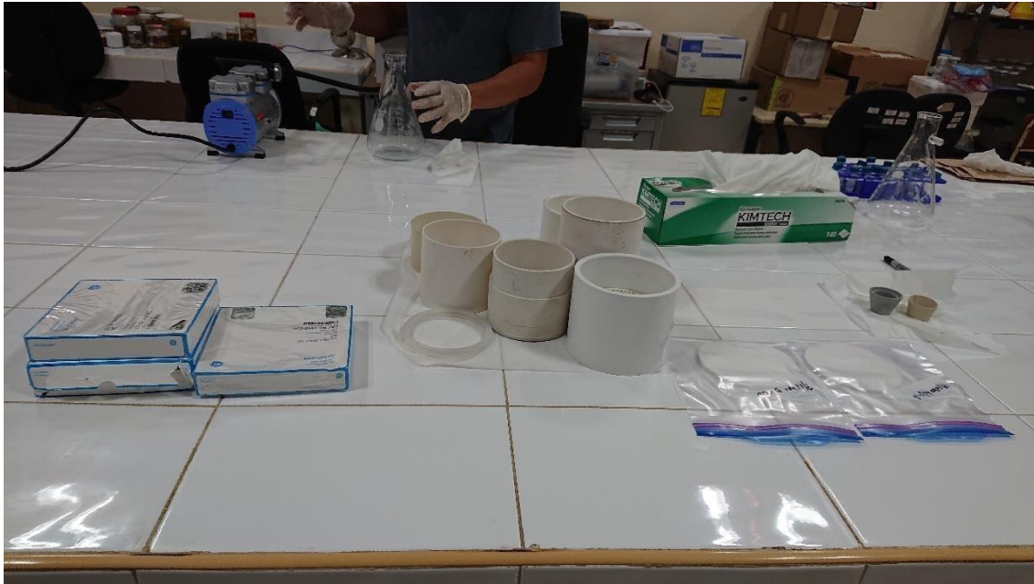
Figura 85. Filtrros de diseño propio usados para el pre-filtrado de las muestras de agua. Fotografías: Martha Valdez Moreno/ECOSUR, 2021.
