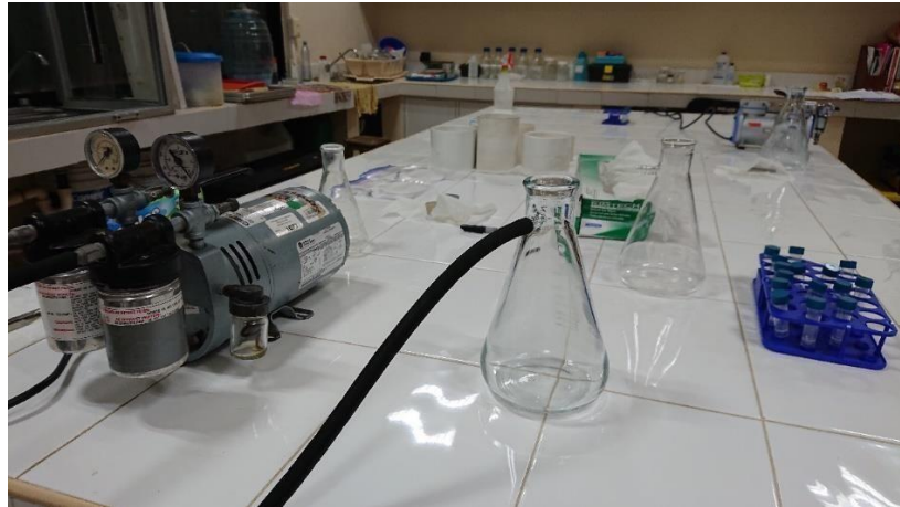
Figura 83. Equipo para la filtración de muestras de ADN medioambiental (bombas de vacío, frascos kitasato, filtros para el agua)
