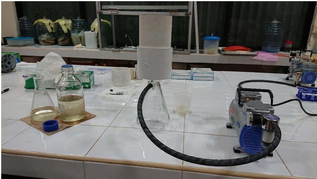
Figura 86. Equipo utilizado para la pre-filtración de las muestras de agua. Fotografías: Martha Valdez Moreno/ECOSUR, 2021.
