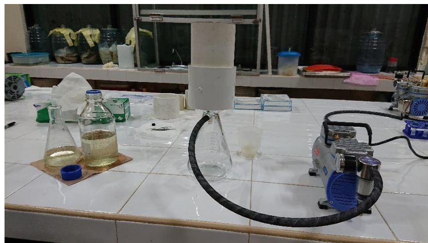
Figura 88. Proceso de pre-filtración de la muestra para eliminar partículas grandes y evitar que los filtros se saturen.
