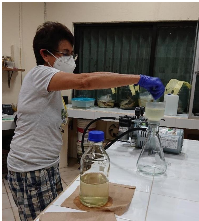
Figura 89. Proceso de segunda filtración de muestras para tomar la muestra final para el ADN medioambiental (bombas de vacío, frasco kitasato con el filtro para el agua).
