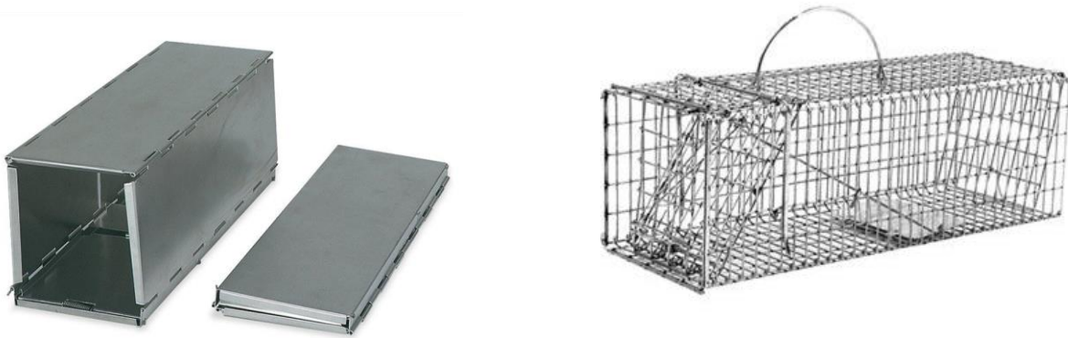
Figura 4. Dispositivos de detección de roedores: trampa Sherman (izquierda) y trampa Tomahawk (derecha).
