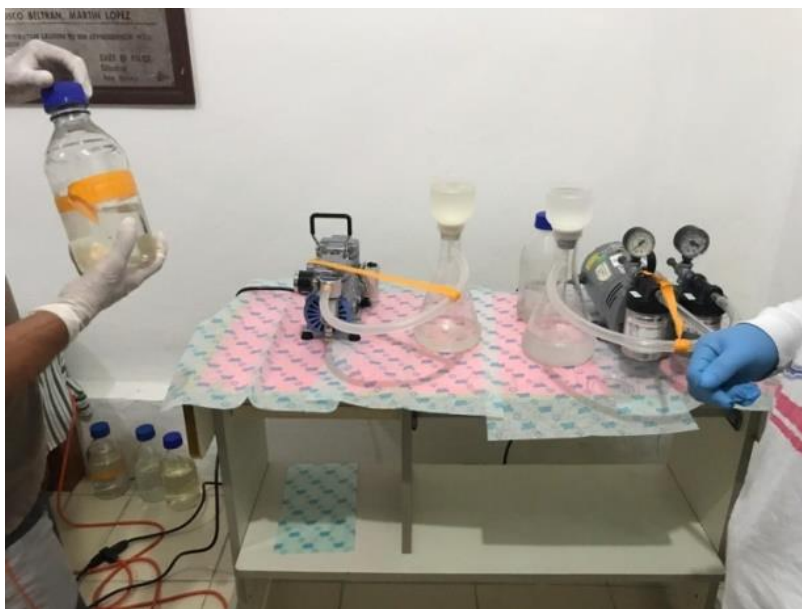
Figura 46. Equipo para la filtración de muestras de ADN medioambiental (bombas de vacío, frascos kitasato con los filtros para el agua) Fotografía: Erika Alarcón Chavira/CONANP, 2019.
