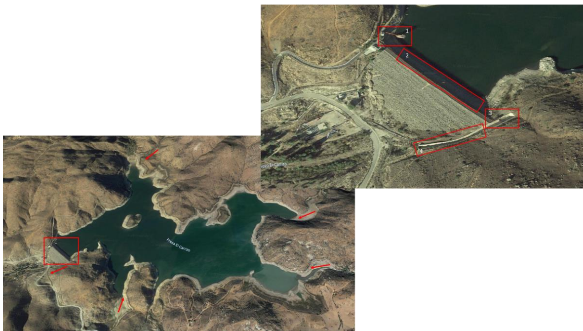
Figura 11. A) Las flechas rojas indican la dirección de los afluentes de la presa el Carrizo. B) Se encerraron en cuadros rojos los sitios más probables en los que se puede establecer el mejillón; 1. Toma de agua; 2. Cortina; 3. vertedor de demasías; 4. Arroyo El Carrizo. (Tomado de Google earth, 2019)
