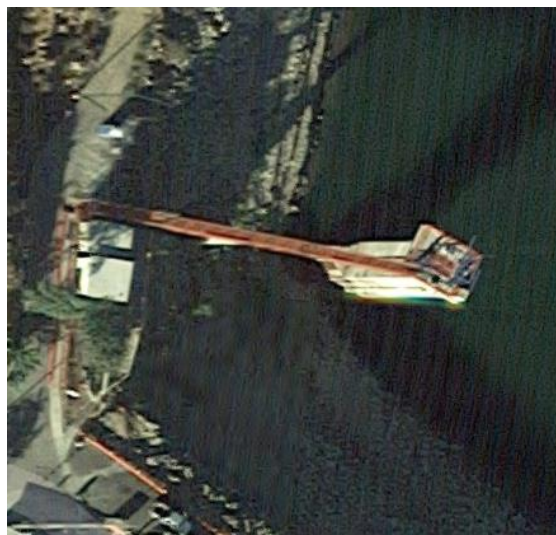
Figura 8. Obra de toma que muestra un grado importante de desecación (Google Earth, 2019), en 2017 operaba a casi la mitad del nivel de la presa. Fuente: http://www.ceabc.gob.mx/documents/indicadores/CIERRE%20DE%20INDICADORES%202017.pdf .
