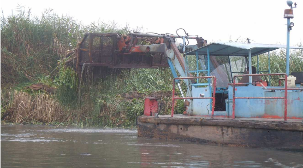
Foto 172. Extracción mecánica del Eichhornia crassipes . Note que la planta es colocada justo en la orilla por lo que, por efecto de viento y peso de la propia planta, ésta se reincorpora al espejo de agua dejando sin efecto las acciones de control
