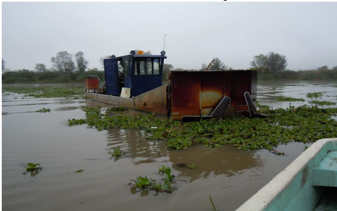
Foto 171. Despalotizadora para control de Tule en el Lago Pátzcuaro
